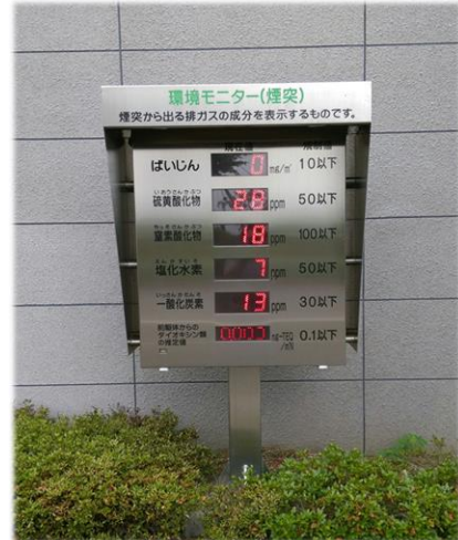
環境モニター（煙突） (鳥栖・三養基西部環境施設組合)
