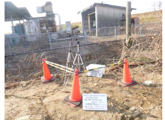
環境騒音・振動、低周波音調査状況
