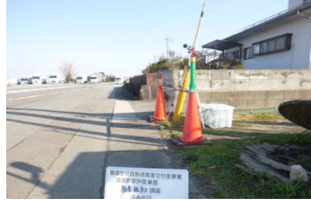
道路交通騒音・振動調査状況
