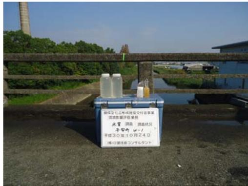
水質調査（降雨時試料採取状況、平常時採取試料）
