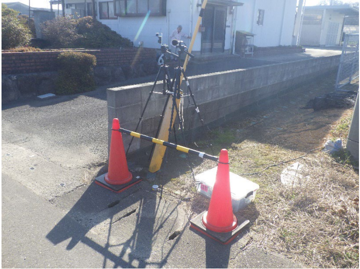
振動測定状況
