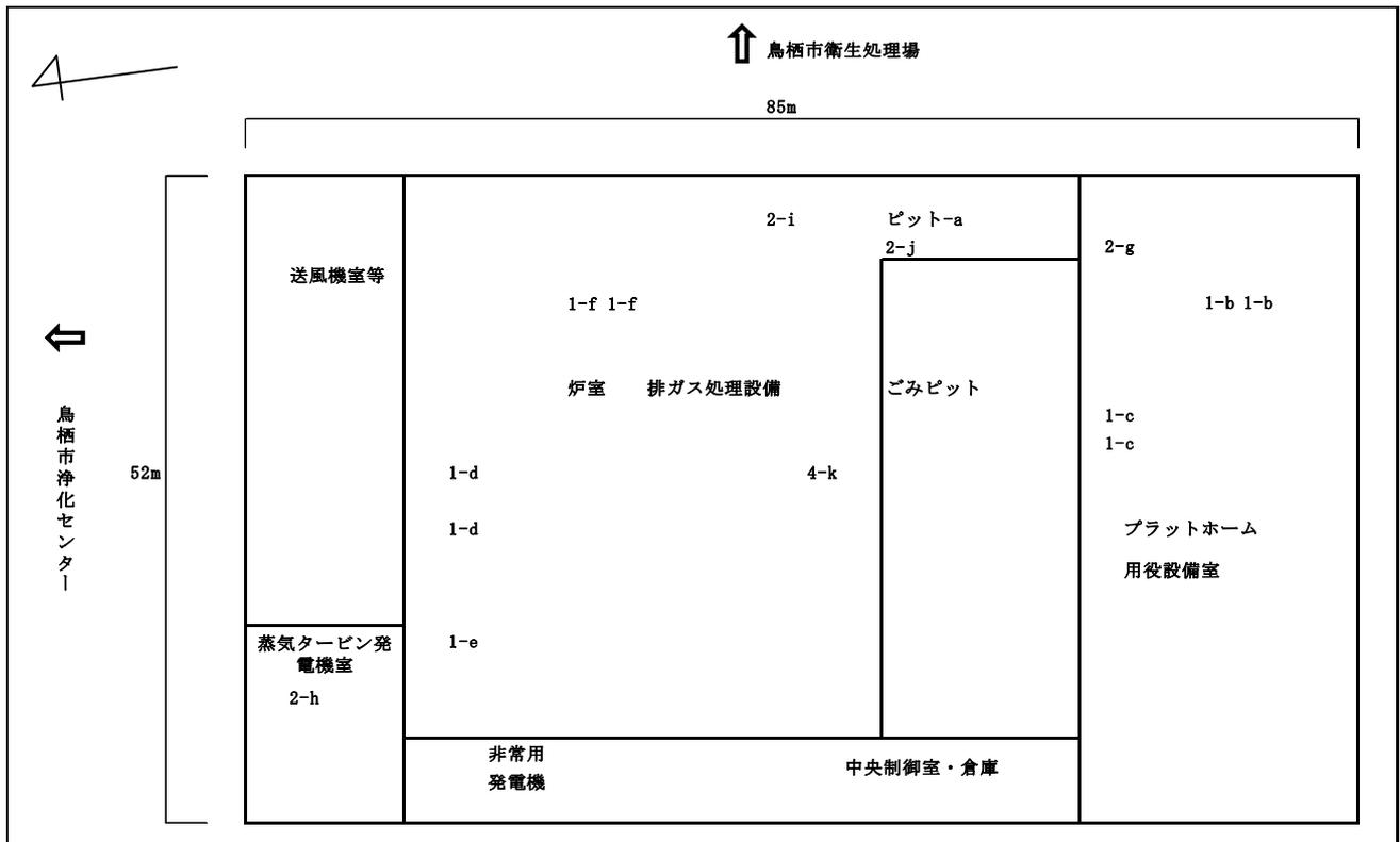
図 9.3.2-2 各機械設備の配置
